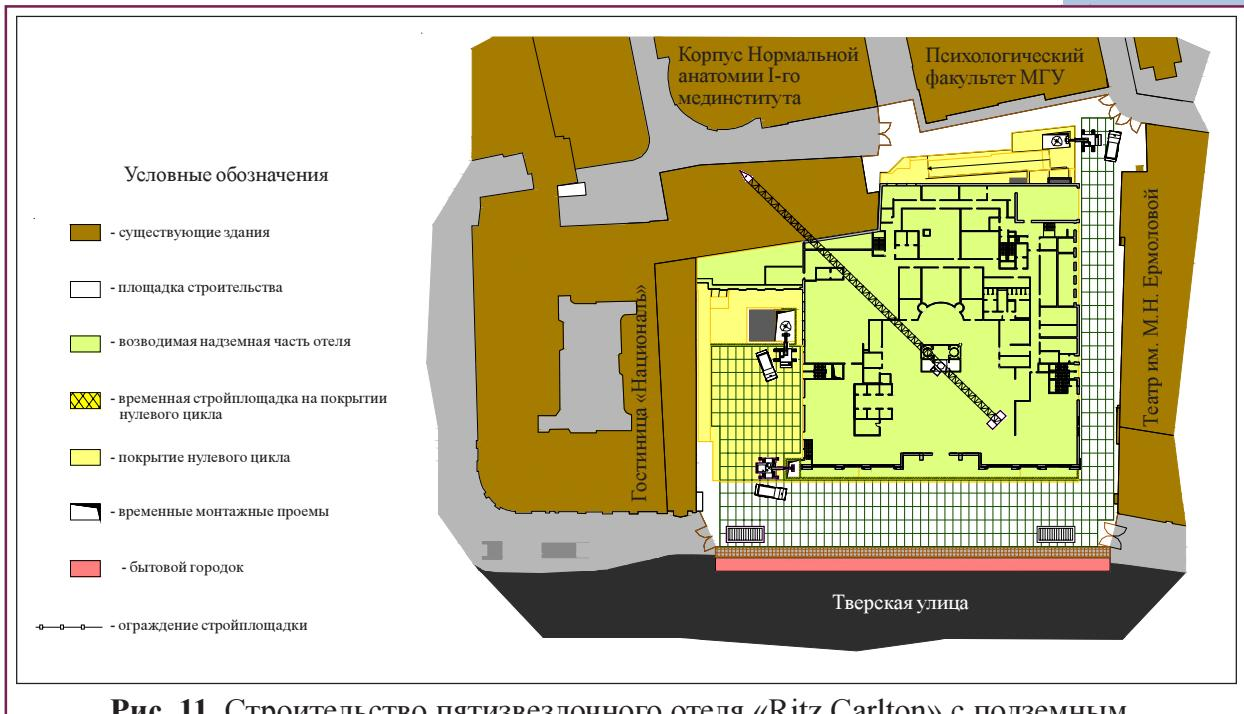
**Рис. 11.** Строительство пятизвездочного отеля «Ritz Carlton» с подземным пятиуровневым пространством. СITUАционный план на стадии завершения экскавации.
