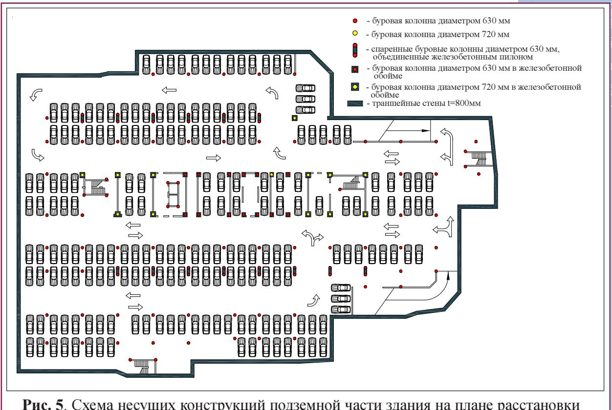
**Рис. 5. Схема несущих конструкций подземной части здания на плане расстановки автомобилей (стрелками указаны направления и зоны проездов).**
