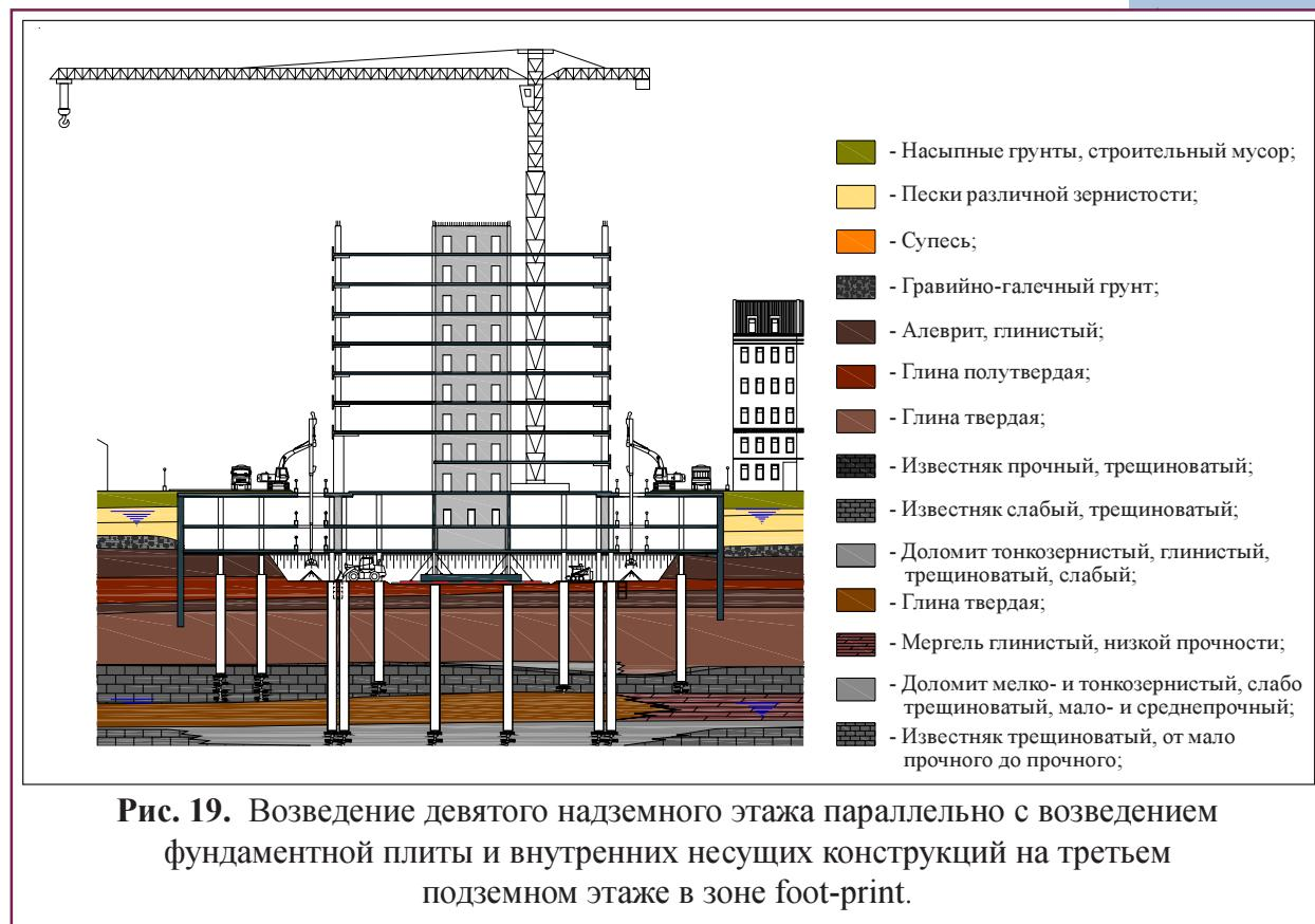
**Рис. 19.** Возвведение девятого надземного этажа параллельно с возведением фундаментной плиты и внутренних несущих конструкций на третьем подземном этаже в зоне foot-print.
