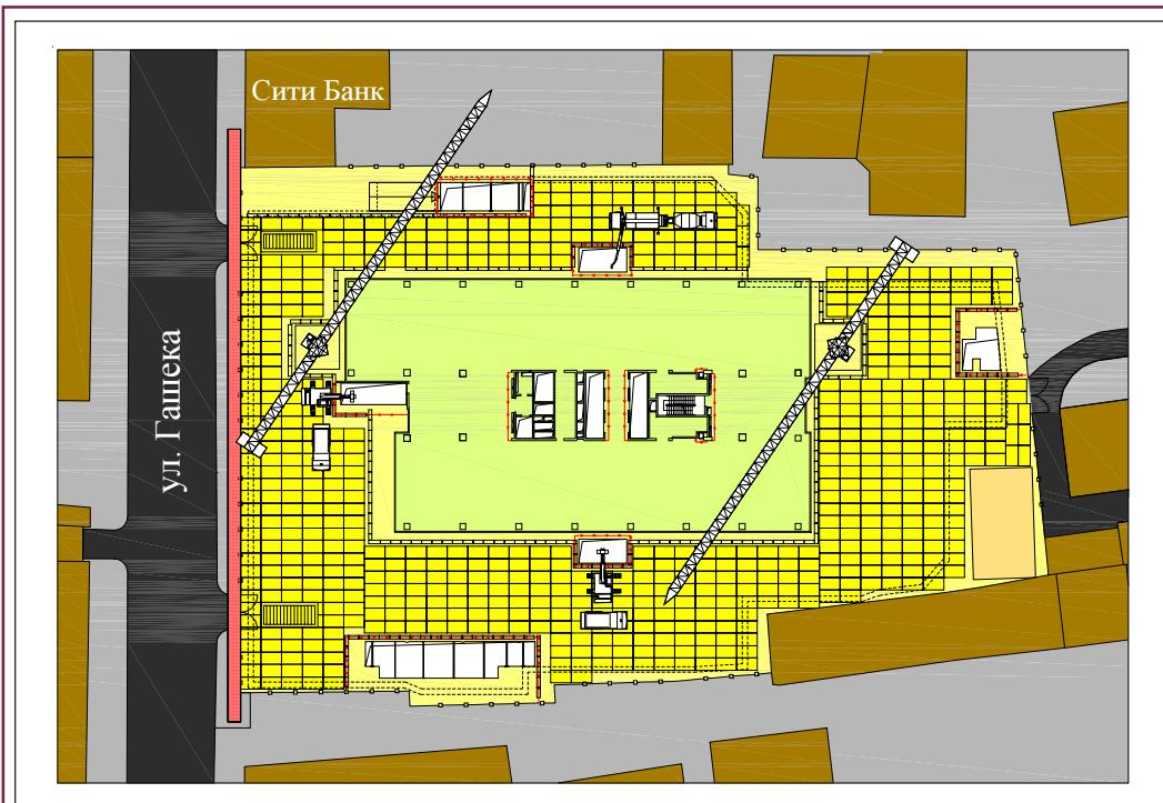
**Рис. 2.** План строительной площадки при параллельном возведении надземных и подземных этажей здания.
