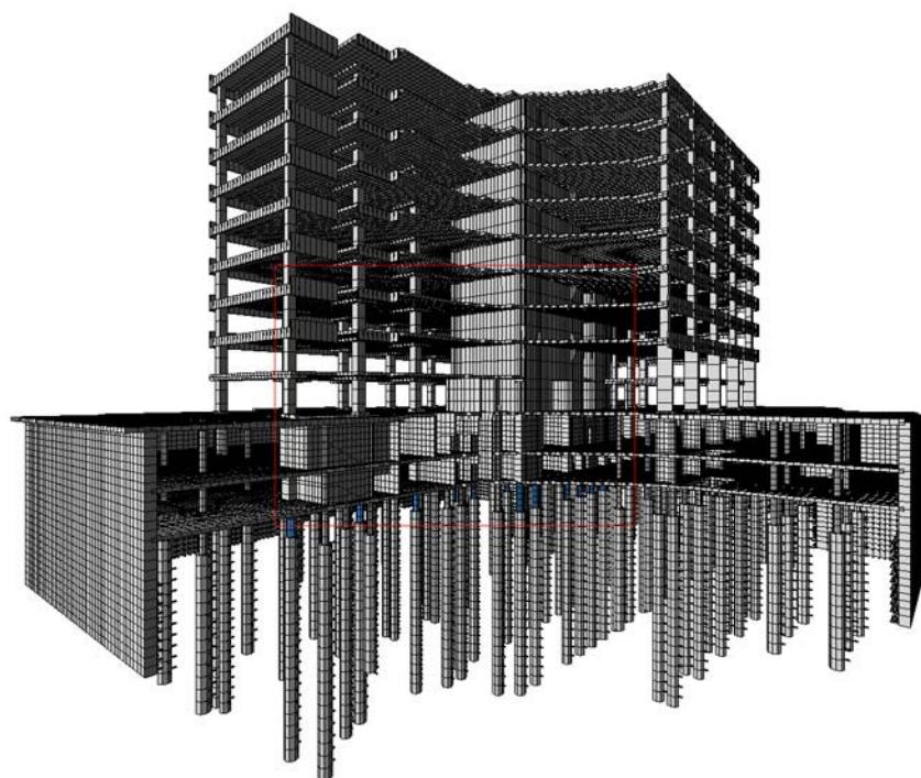
**Рис. 6.** Расчетная 3D-модель несущих конструкций здания на стадии завершения экскавации грунта в котловане (девять надземных этажей возведены раньше фундаментной плиты).
